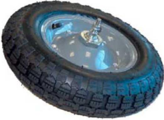
Rueda neumática de 350x8. Especial remolque. Disco metálico. Con cámara interior y válvula. Cubierta de caucho. Estructura muy fuerte. Fijada con tornillos. Eje con rodamientos y tuercas de fijación.
