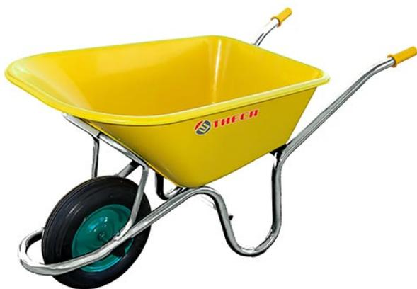
Carretilla apropiada para usar en construcción por su bandeja estrecha y profunda que sirve para transportar sólidos poco densos y líquidos. Bandeja de nylon. Capacidad: 100 L. Medida bandeja: 570x950 mm. Bastidor tubo acero  $\varnothing 32 \times 1,5$  mm. Rueda neumática de 350x8. Bandeja nylon amarillo. Por sus medidas cabe entre el marco de una puerta y pasillos de andamio.
