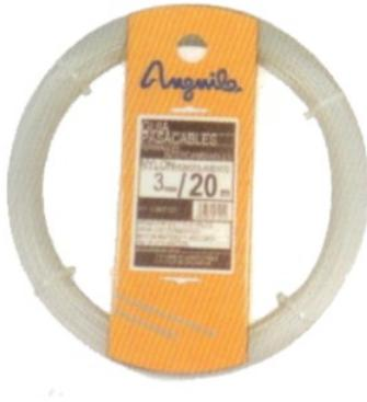
Pasacables doméstico. Son muy flexibles y giran con facilidad. Cableado eléctrico interior, informática, telecomunicación. Nylon macizo de 3 mm. terminal fijo. Color negro natural. Resistencia tracción: 100 Kg. Diámetro de giro: 2 Cm. Diámetro tubo ideal: 16-20 mm.
