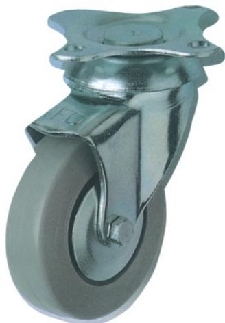
NORMA ISO 2175 E ISO EN 12527. Soporte giratorio de acero es- tampado platina base sujeción horizontal 4 tornillos. Rodamiento de un hilera axial de bolas de acero. Acabado en blanco brillante. Aro monobloque de goma gris hasta 60 mm. e inyectado sobre núcleo de nylon color marfil para las siguientes. Rodamiento de buje con taladro liso. Acabado platinas laterales de acero estampado. Diámetro rueda: 42x17 mm. Altura con soporte: 58 mm. Hueco tornillo soporte: 6.5 mm
