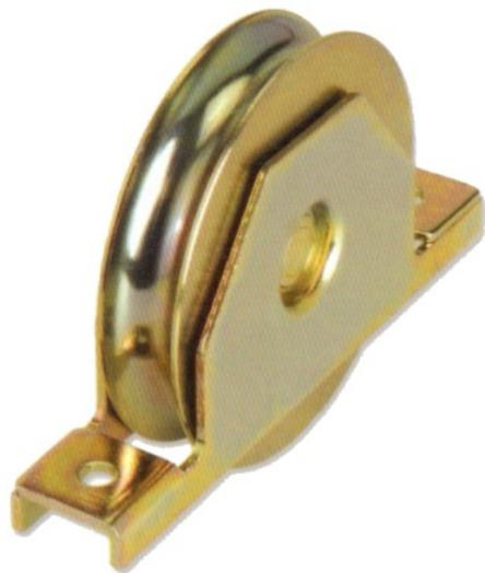
CERTIFICADO ISO 9001. Rueda 1 cojinete canal U. con soporte para encastrar. Se deslizan sobre rail acero acero diámetro 20 mm. Acero zincado. Diámetro: 100 mm. Peso máximo: 230 K. Ancho rueda: 24 mm. Ancho con soporte: 35 mm Largo con soporte: 159 mm. Automatismos y herrajes para puertas de corredera.
