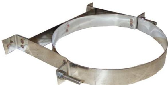
Accesorios de salida de humos. Para estufas, barbacoas, etc. Abrazadera de acero inoxidable para atornillar a la pared. Con dos tornillos para sujetar el tubo. Diámetro: 110 mm. AISI 304 18/10 CrNi. Pared simple de 0,5 mm.
