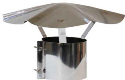
Accesorios de salida de humos. Para estufas, barbacoas, etc. Sombrerete de acero inoxidable con dos tornillos para fijar la parte abierta al tubo con seguridad. Diámetro: 120 mm. Encaje perfecto con accesorios AISI 304 18/10 CrNi. Pared simple de 0,5 mm.
