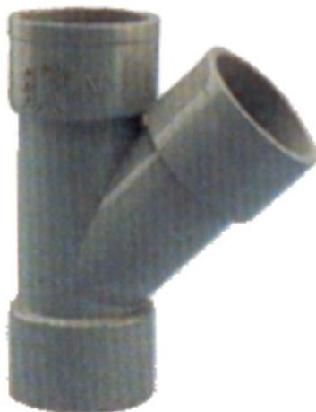
CERTIFICADO ISO 9001. NORMA UNE EN ISO 1453-1329 NORMA UNE 13501-1 REACCION AL FUEGO CON EURO CLASE B-s1-d0. Injerto hembra-hembra. Sistema de evacuación de agua. Evacuación de aguas residuales de uso doméstico a baja y alta temperatura. Canalización agua pluvial en interior edificio.
