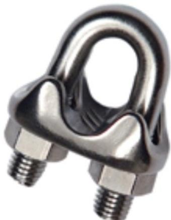
ISO 9001-ES041483 1-CE EN 795. Sujetacables de acero Fe 360-B fabricados por fundición y con acabado inoxidable. Especial náutica. Cuerpo especial adecuado para cada diámetro de cable. Lo que evita deslizamientos. Fabricado bajo norma DIN 741. Unión u sujeción de cables.
