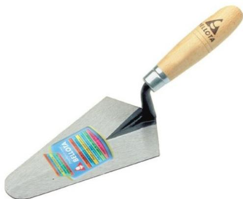
Forjada en una sola pieza. Excelente flexibilidad. Fijado perfecto mango-espiga epoxi. Mango madera haya y bimetálico. Fibras acero unidireccionales. Resistencia a 0,6 TN. Preparar y aplicar cemento mortero. Peso: 325 Gr. Medidas: 227x122 mm.
