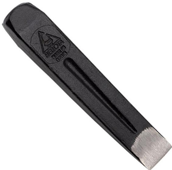
Cuña forjada para cortar y romper la madera. Es el complemento de la maza o de la maza-cuña. Gran durabilidad, están forjadas de una sola pieza y tratadas térmicamente para que no se rompa ni se deforme durante el uso. El filo está pulido y afilado para que la penetración en el tronco sea más fácil y partir el tronco sea más limpio y cómodo. Peso: 2500 Gr. Medidas: 255x40 mm.
