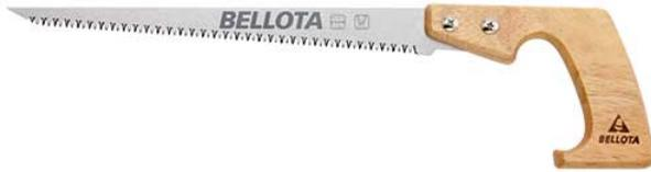
Serrucho de punta profesional con dentado japonés de triple filo (7 TPI) para un corte rápido, limpio y preciso, con doble tratamiento térmico en la zona de corte para un mayor rendimiento. Mango de madera de haya que procede de bosques gestionados de forma sostenible y fuentes controladas (PEFC/14-35-00020). Para corte de madera, aglomerado, yeso, plástico y otros materiales. Longitud de la hoja: 316mm. Número de dientes por pulgada: 7. Dimensiones: 455 x 105 x 25 mm. Peso: 0,19 Kg.
