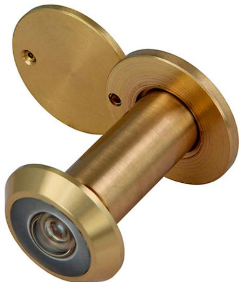
Mirilla superangular para puertas. En envases individuales. Tapa trasera maciza. Lente óptica de alta calidad. Ángulo de visión superangular de 160 grados. Construcción en latón macizo. Cubierta trasera especial, que proporciona el más alto nivel de protección y seguridad. Diámetro: 14 mm. Grosor de la Puerta: 35-60 mm. Acabado: Pulido.
