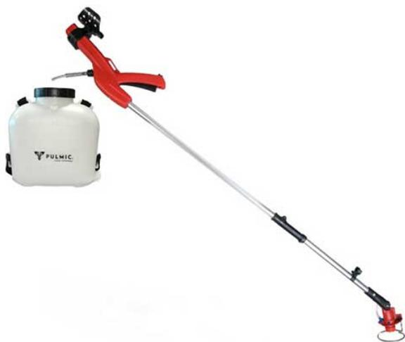
El pulverizador UBV Pulmic Fenix es una máquina fabricada en aluminio, es ligera, gracias a sus 700gr de peso. Su apoyabrazos, facilita el trabajo del usuario ofreciendo una mayor comodidad. Se trata de un pulverizador hidráulico centrífugo, manual, para aplicación de herbicidas sistémicos en ultra bajo volumen. Caña plegable, boquillas intercambiables, aro metálico protector de hierbas y golpes, y disco con laberinto para evitar la entrada de humedad al motor.
