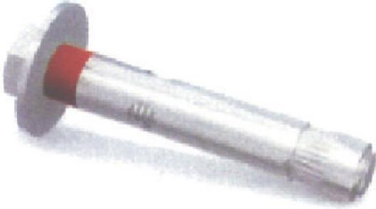
Anclaje metálico de expansión mediante rosca para cargas ligeras Acero inoxidable A.2 Compuesto de tornillo y arandela Din 9021 Para montajes en materiales macizos en ambientes donde se requiera buen comportamiento contra corrosión
