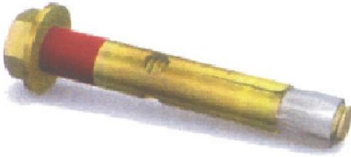
Anclaje metálico de expansión mediante rosca para cargas li-geras Acero cincado electrolítico de 5 micras de espesor Tornillo de acero calidad 6,8 Para fijación en hormigón ma-teriales macizos.
