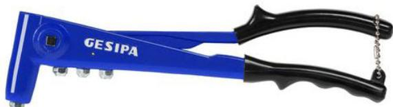
Pone remaches de hasta 5 mm Ø de aluminio y 4 mm Ø de acero y inoxidable. Carcasa de aluminio fundido a presión de alta calidad. Brazo de la tenaza de acero forjado. Cabezal de la tenaza estrecho para acceder a puntos de remachado difíciles. Resorte de apertura para expulsión automática del vástago. Mango ergonómico. Peso: 480 g. Longitud total: 275 mm. Carrera del aparato: 8 mm. Equipamiento: Boquillas 10/18, 10/24, 10/27 y 10/32, y 1 llave de montaje.
