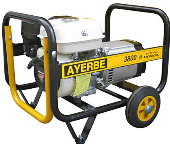
Motor HONDA GP160A-5.5HP-3600R . Potencia: 3,8 kva-3000w. Tensión:220v-50 hz. Nivel sonoro:96 db. Arranque manual de plástico. Peso:47,0 kg. MOTOR:Válvulas en cabeza. Disyuntor térmico. Seguridad aceite. Consumo 1,1 l/h-Depósito:3,6l.
