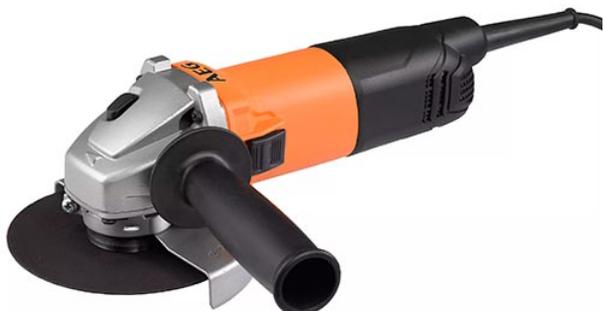
Potente motor de 800W. Diámetro del disco 115mm. Relé de baja tensión, que evita el arranque accidental de la maquina después de una desconexión. Caja de engranajes metálica para más durabilidad. Salida directa del aire. Entradas de aire protegidas. Bloqueo del eje. Suministrada con empuñadura, protector, tuerca, contratuerca y llave de pivotes. Máx. profundidad de corte 26mm. Tamaño del eje M14. Velocidad máx. 12.000rpm. En caja de cartón.
